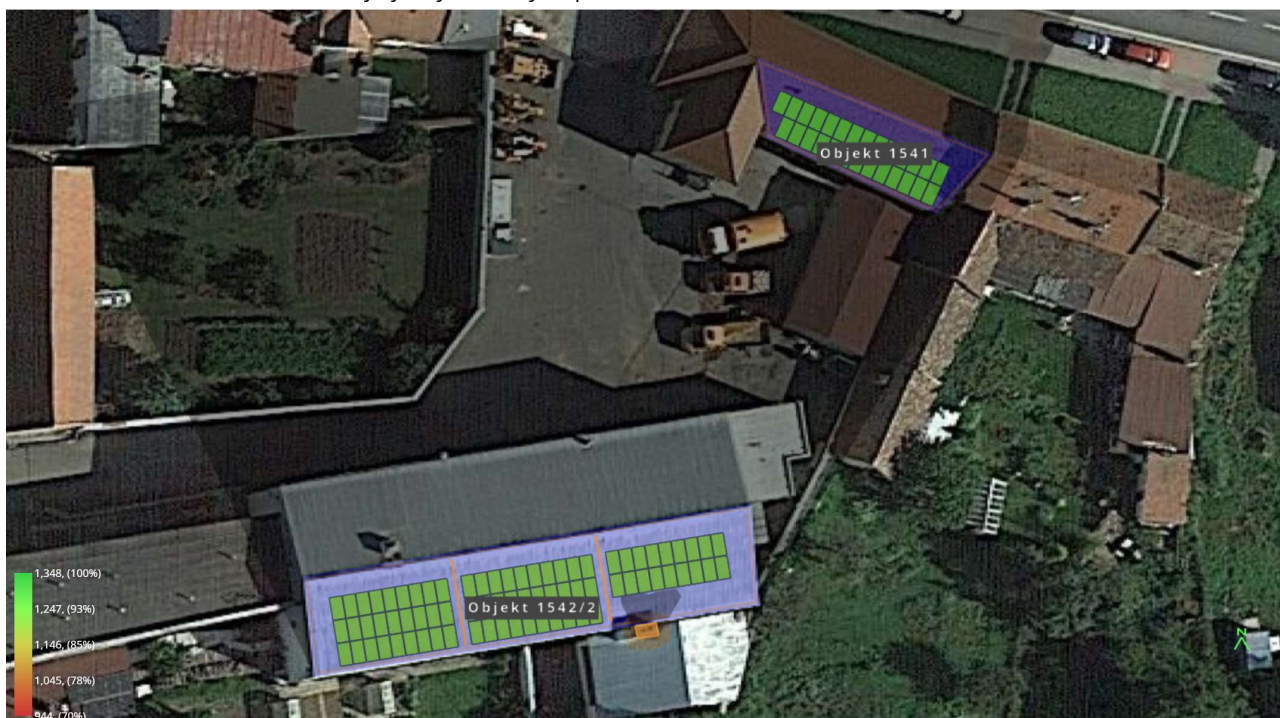
Obrázek č. 4.9.4.5: Schéma efektivity výroby elektřiny FV panelů
